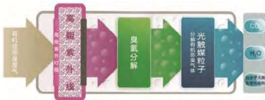
图 7.2-2 UV 光氧催化处理流程示意图
