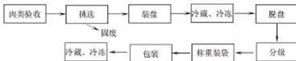
图 2.1-4 项目冷冻、冷藏工艺流程及产污环节图
